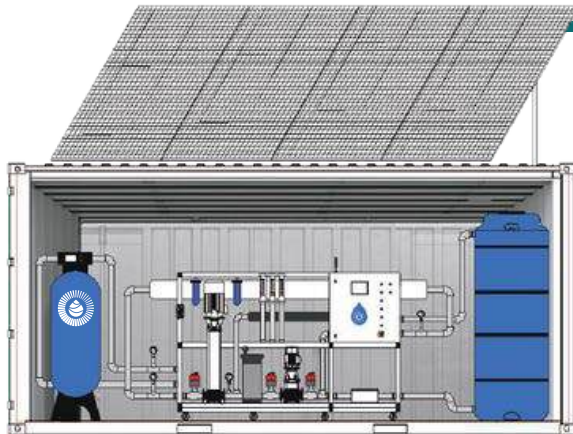
Sistema containerizado de desalinización solar de 20ft
